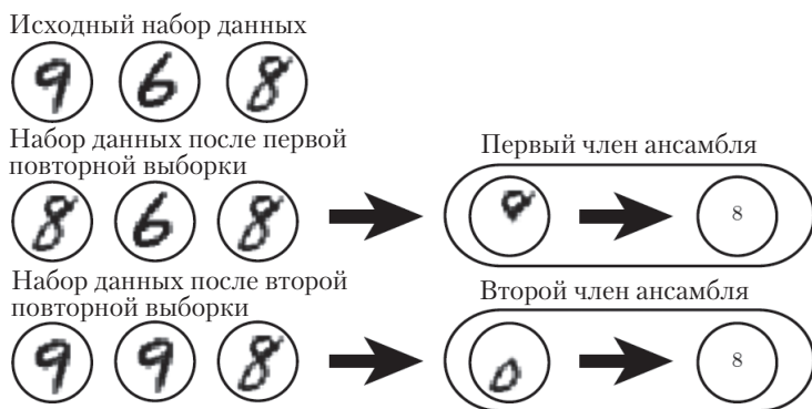
Рис. 7.5 ❖ Иллюстрация работы баггинга. Допустим, что мы обучаем детектор цифры 8 на показанном наборе данных, содержащем 8, 6 и 9. Предположим, мы хотим создать два разных набора данных на основе исходного. Процедура баггинга строит каждый набор путем выборки с возвращением из исходного набора. В первом наборе отсутствует 9, но два раза встречается 8. На этом наборе данных детектор научится, что кружочек в верхней части цифры соответствует 8. На втором наборе повторяется 9 и отсутствует 6. В этом случае детектор научится, что кружочек в нижней части соответствует 8. Каждое правило по отдельности ненадежно, но если усреднить результаты, то получится робастный детектор, дающий максимальную уверенность, только когда присутствуют оба кружочка
