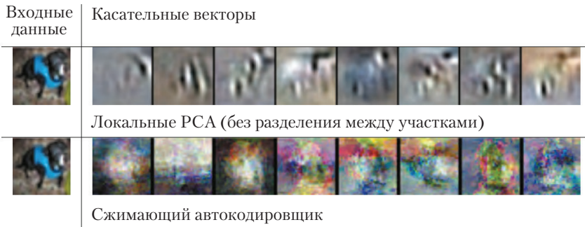
Рис. 14.10 ❖ Касательные векторы к многообразию, оцененные локальным методом главных компонент (PCA) и сжимающим автокодировщиком. Позиция на многообразии определяется входным изображением собаки, взятым из набора данных CIFAR-10. Для оценки касательных векторов используются первые сингулярные векторы матрицы Якоби \partial \mathbf{h} / \partial \mathbf{x} отображения входа на код. Хотя и PCA, и CAE могут найти локальные касательные, CAE дает более точные оценки на ограниченном объеме обучающих данных, поскольку в нем присутствует разделение параметров между разными позициями, совместно использующими некоторое подмножество активных скрытых блоков. Касательные направления, найденные CAE, обычно соответствуют перемещающимся или изменяющимся частям объекта (скажем, голове или лапам). Изображение взято из работы Rifai et al. (2011c) с разрешения авторов
